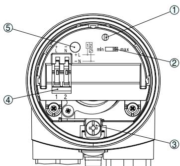
Отсек электроники и подключения - бесконтактный переключатель
